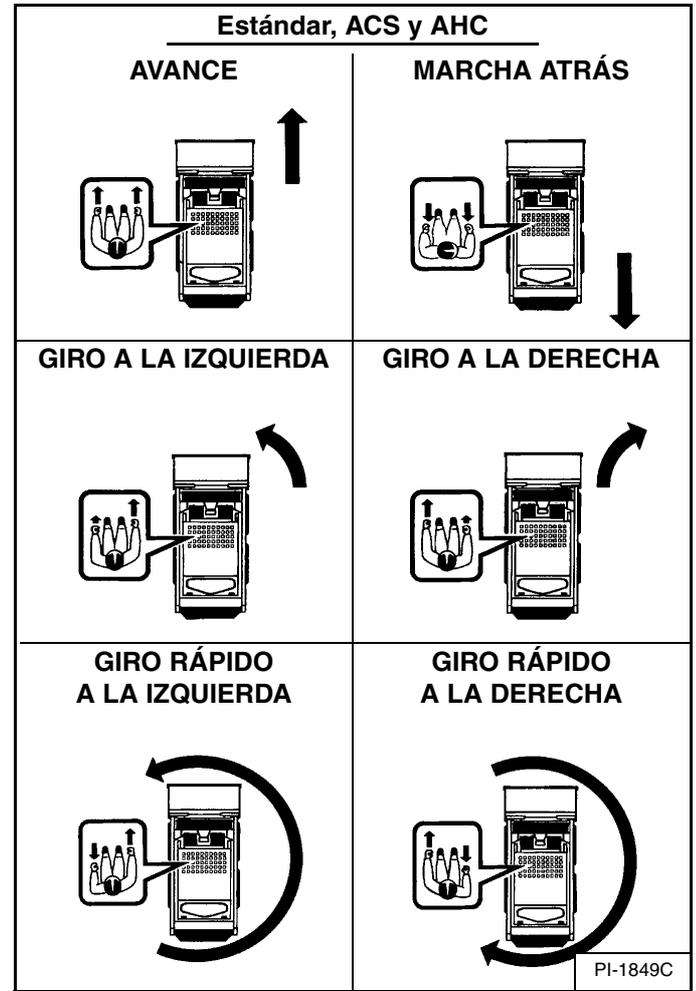
Las palancas de dirección controlan los movimientos hacia delante y hacia atrás, así como el giro de la cargadora [Figura 49].
