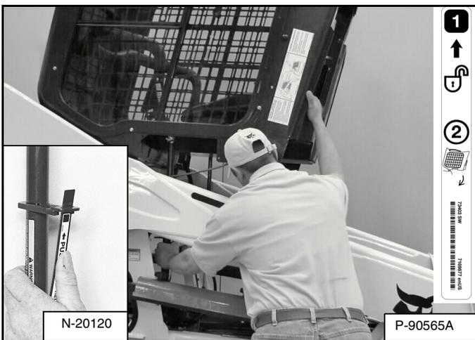
Tire hacia abajo de la parte inferior de la cabina del operador hasta que se detenga en el mecanismo de cierre [Figura 186].
