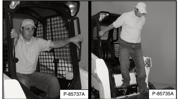
Salga de la cargadora utilizando las agarraderas, las huellas de seguridad y los escalones (mantenga siempre 3 puntos de contacto) [Figura 125].
