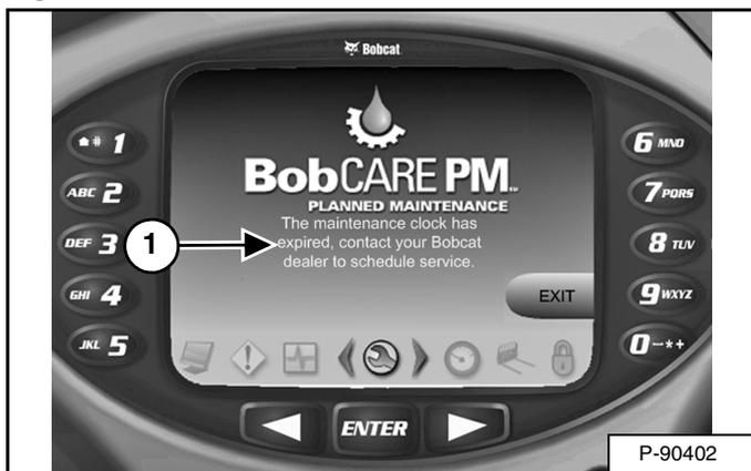
El tablero de instrumentos Deluxe, si está equipado, mostrará un mensaje (1) [Figura 292] que avisará al operador de que debe realizar el servicio de la máquina.
