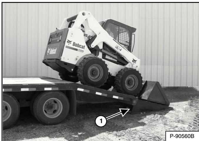
Cuando la cargadora tiene el cucharón vacío o no tiene ningún implemento, debe cargarse marcha atrás en el vehículo de transporte [Figura 171].
