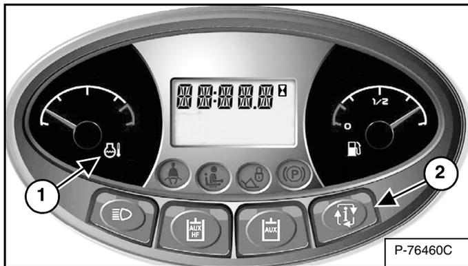
Vigile con frecuencia los indicadores de temperatura y de combustible, así como las luces del BICS™ (todas deben estar APAGADAS para poder manejar la cargadora) [Figura 122].
