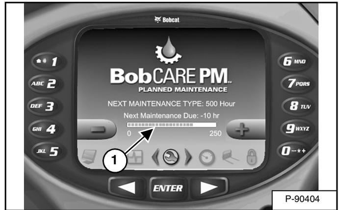
El tablero de instrumentos Deluxe, si está equipado, mostrará una barra (1) [Figura 293] que indicará el tiempo que queda hasta el próximo mantenimiento. Esta barra se volverá roja cuando el mantenimiento esté pendiente. PRÓXIMO MANTENIMIENTO PREVISTO EN PASARÁ A SER MANTENIMIENTO PENDIENTE HACE y se mostrará la cantidad de horas que lleva pendiente.
