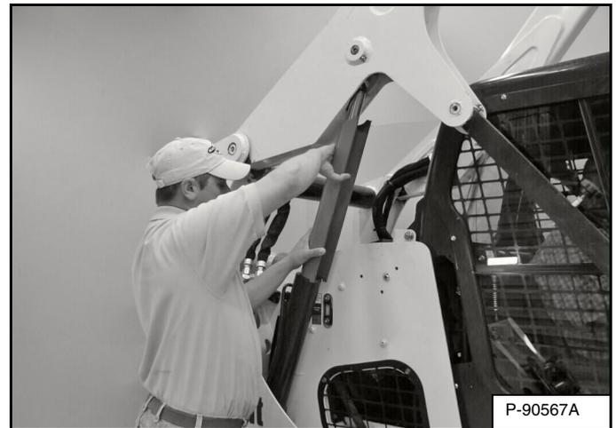
Utilice la ayuda de otra persona para instalar el seguro de los brazos de elevación sobre el vástago de uno de los cilindros de elevación [Figura 177].
