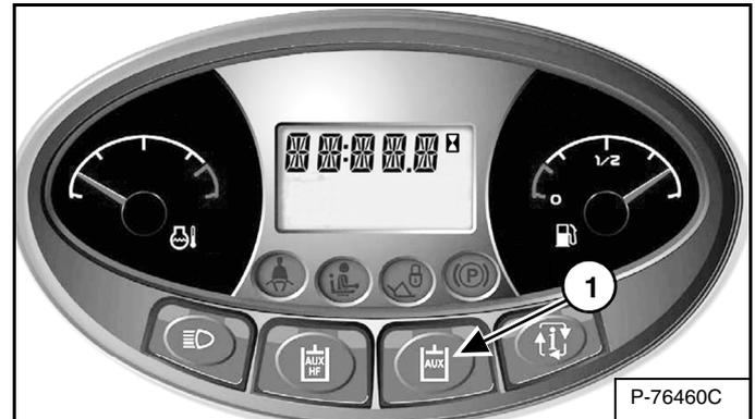
Pulse el botón de hidráulica auxiliar (1) [Figura 89].
