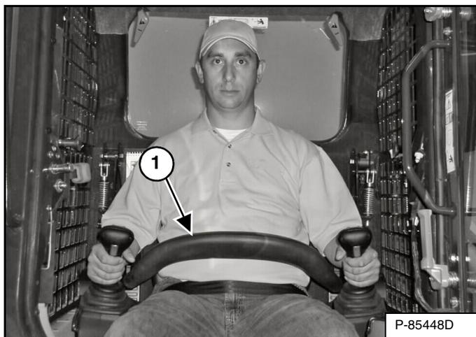
El sistema Bobcat de bloqueo interfuncional (BICS™) dispone de una barra de seguridad basculante con reposabrazos (1) [Figura 32]. El operador controla el uso de la barra de seguridad.
