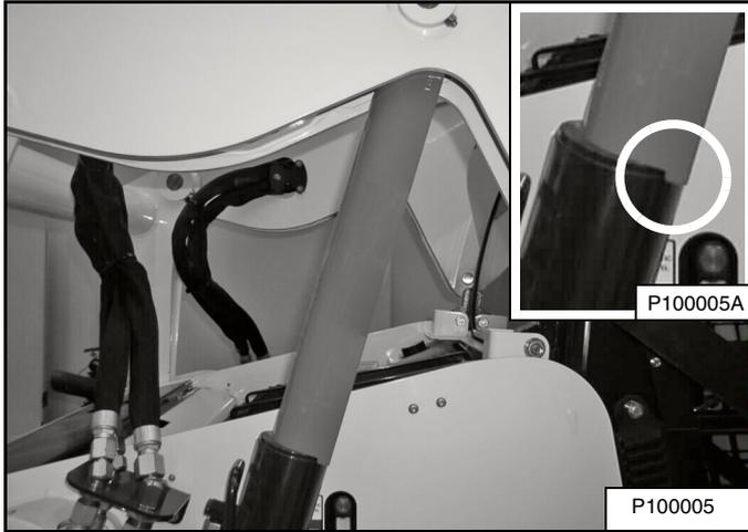
Baje lentamente los brazos de elevación hasta que el seguro quede sujeto entre el brazo y el cilindro de elevación **[Figura 178]**. Las lengüetas del seguro de los brazos de elevación deben sobrepasar el extremo del cilindro (inserto) **[Figura 178]**.
