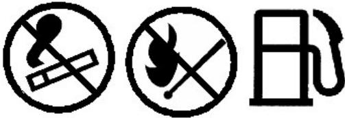
Para añadir combustible, pare el motor y déjelo enfriar. ¡No fume! No reposte una máquina cerca de llamas abiertas o chispas. Reposte el depósito de combustible al aire libre.
