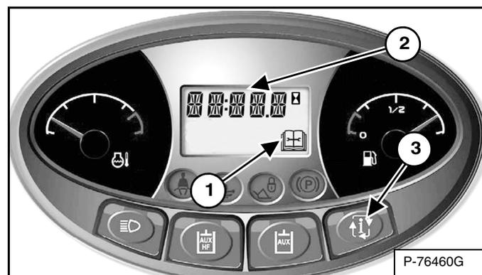
Es importante cambiar el filtro de aire solamente cuando sea necesario. El indicador de servicio (1) PARPADEARÁ. Pulse el botón de información (3) hasta que el visualizador de datos (2) muestre los códigos de mantenimiento. Cuando sea necesario cambiar el filtro, en la pantalla de visualización (2) [Figura 201] aparecerá el código de mantenimiento [M0117] (Filtro de aire obstruido).
