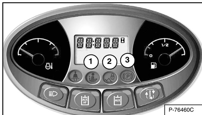
Hay tres luces de visualización (1, 2 y 3) [Figura 33] en el tablero de instrumentos izquierdo que deben estar APAGADAS para poder usar todas las funciones de la máquina.
