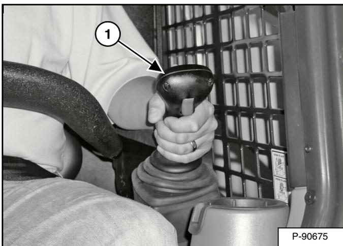
El joystick que controla la tracción y la dirección se encuentra en la parte izquierda delantera del asiento (1) [Figura 51].
