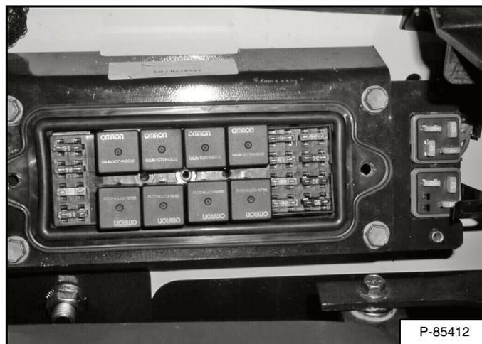
Retire las tapas para comprobar o sustituir los fusibles [Figura 224].
