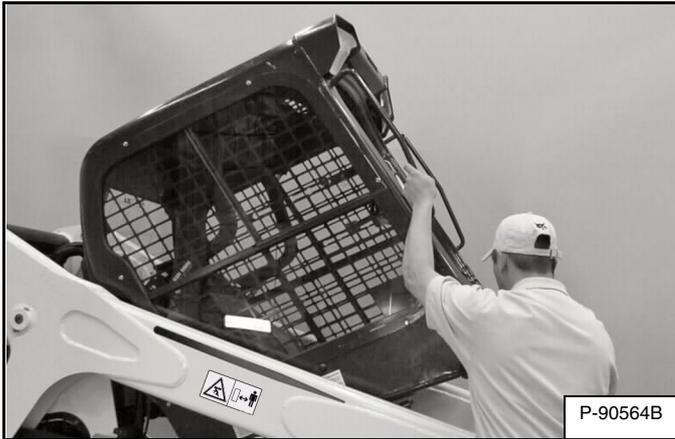
Suba la cabina [Figura 185] lentamente por medio de las agarraderas y tomándola del borde inferior, hasta que esté completamente elevada y el mecanismo de cierre activado.
