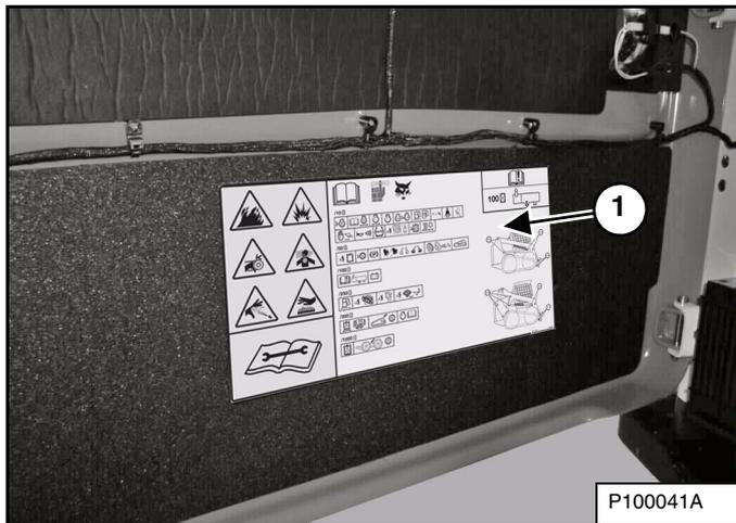
La Lista de comprobaciones y programa de mantenimiento (1) [Figura 96] se encuentra en la cara interna del portón trasero de la cargadora.
