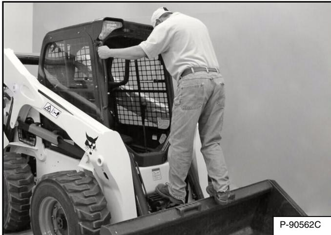
Utilice los peldaños del cucharón o del implemento, las agarraderas y las huellas antideslizantes (en los brazos de elevación y el chasis de la cargadora) para entrar y salir de la cargadora [Figura 97]. No salte.
