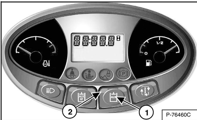
Pulse una vez el botón de hidráulica auxiliar (1) [Figura 83] para activarla.
