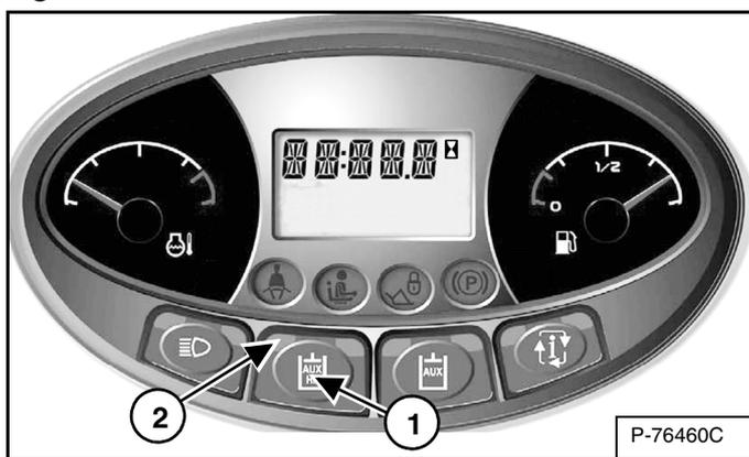
Pulse el botón de ALTO CAUDAL (1) [Figura 87] para activar el funcionamiento de la hidráulica auxiliar de alto caudal.
