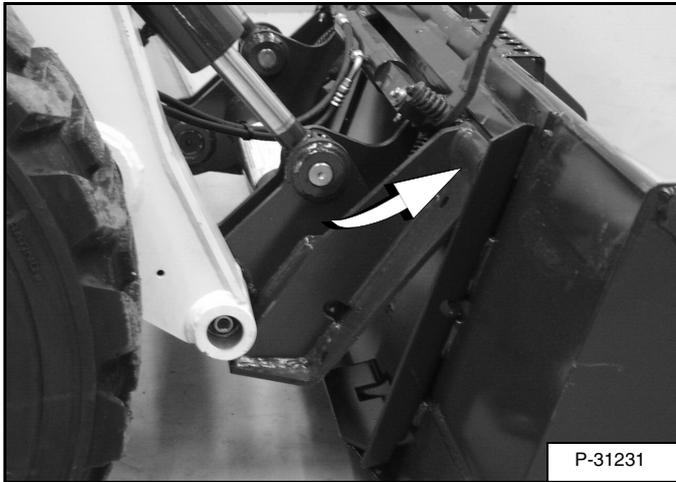
Adelante lentamente la cargadora hasta que el borde superior del Bob-Tach™ quede completamente debajo de la brida superior del chasis de montaje del cucharón [Figura 136] (u otro implemento).
