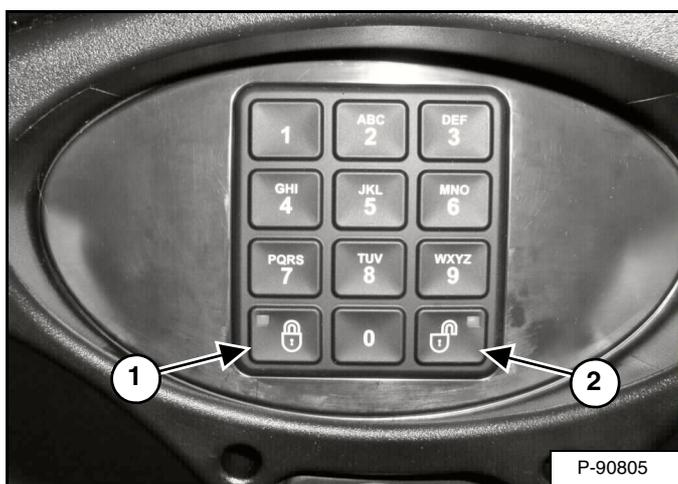
Pulse y mantenga pulsadas las teclas de bloqueo (1) y desbloqueo (2) [Figura 286] durante dos segundos.
