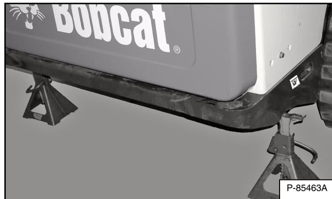
Coloque soportes mecánicos bajo la parte trasera del chasis de la cargadora [Figura 183].
