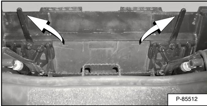
Tire de las palancas del Bob-Tach™ [Figura 132] hasta que estén completamente levantadas (las cuñas completamente extendidas).
