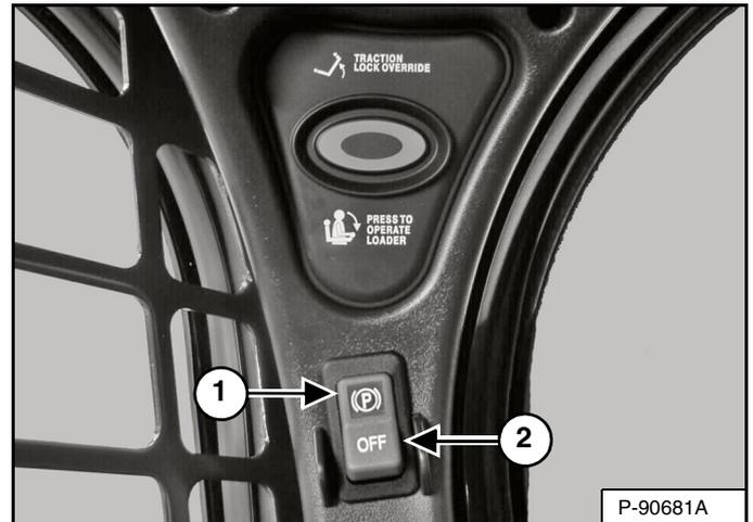
Pulse la parte superior del interruptor (1) [Figura 35] para activar el freno de estacionamiento. La luz roja del interruptor se encenderá. Al hacer esto, el sistema del mecanismo de tracción se bloqueará.
